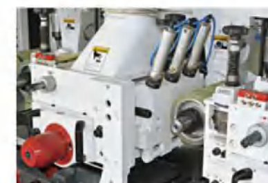
上刀軸之氣壓式壓料機構
