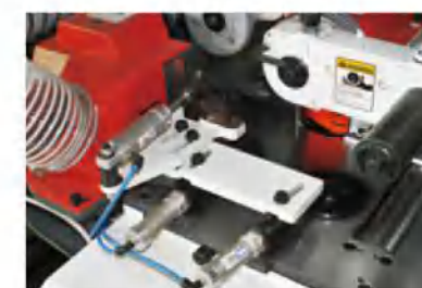
右刀軸對面之氣壓式壓料機構
