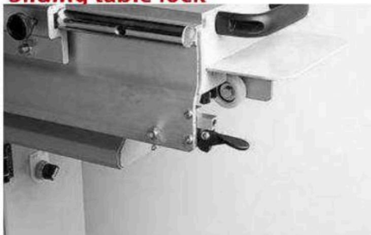
滑動工作台-上鎖 Sliding table lock
