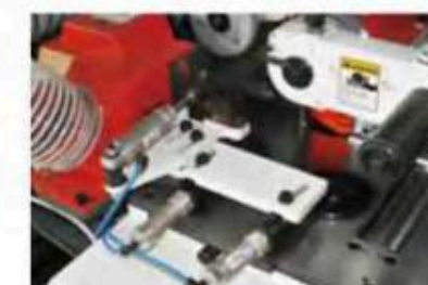
右刀軸對面之氣壓式壓料機構
