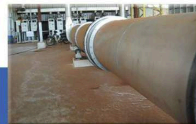
木屑乾燥滾桶設備流程 WET WOOD FLOUR DRYER
