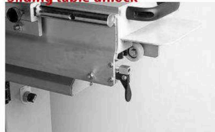
滑動工作台-未鎖 Sliding table unlock
