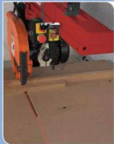
雷射紅外線 Infrared Laser Equipment
