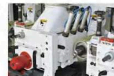
上刀軸之氣壓式壓料機構
