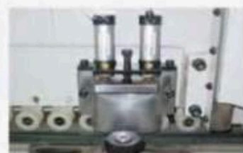
立轴加装气压式上下导板 附加调压阀可微调压力
