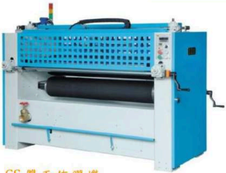
CS 單面佈膠機 CS Single-side Glue Spreader
